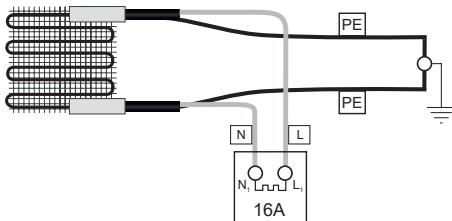
**!** Для правильного подключения двухжильного нагревательного мата к терморегулятору необходимо завести монтажный вывод в корпус терморегулятора.
