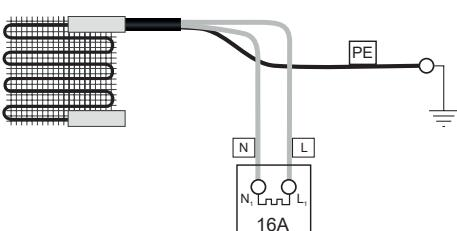
**!** Для правильного подключения одножильного нагревательного мата к терморегулятору необходимо завести ОВА монтажных выводов в корпус терморегулятора.
